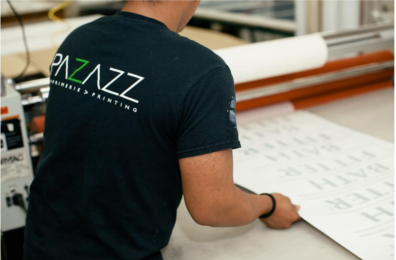
Un membre de l'équipe de production Pazazz utilise notre AT-K7110, un ruban de transfert qui est utilisé sur les panneaux et les logos en vinyle afin qu'ils puissent être appliqués et installés correctement.
